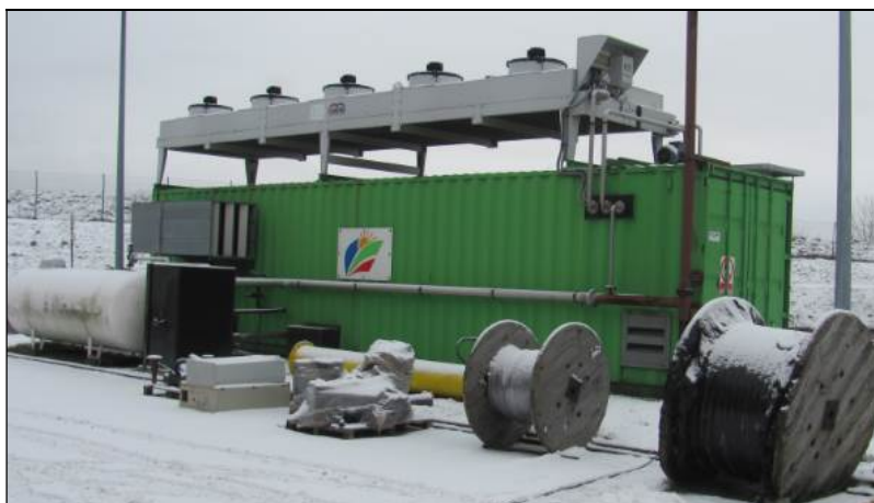
Rysunek 3.8 Waloryzacja biogazu metodą membranową, fot. proGEO
