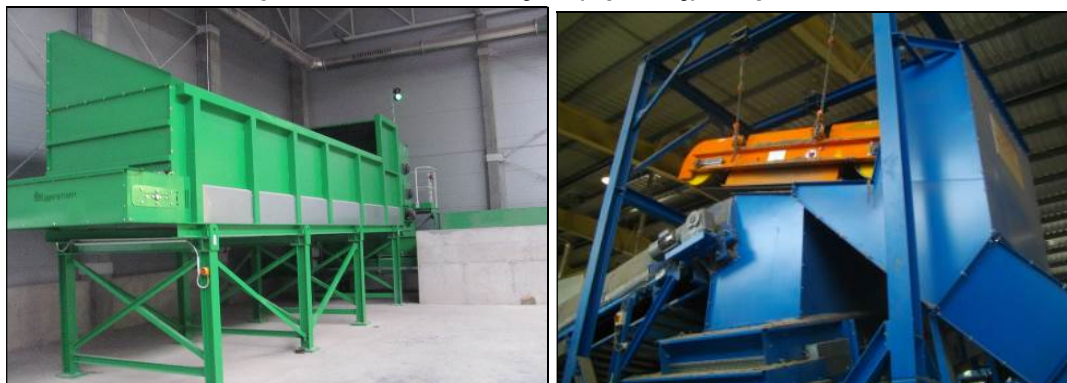
Rysunek 3.2. Rozrywarka worków dla frakcji biodegradowalnej (z lewej), Separator metali żelaznych (z prawej) fot. proGEO
