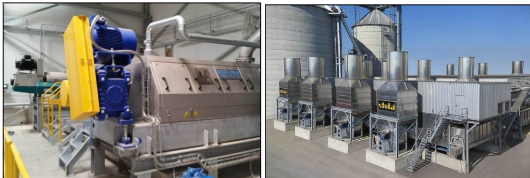
Rysunek 3.4 Przykład modułu odwadniania pofermentatu, (fot. proGEO) oraz suszarnia taśmowa, (materiały reklamowe Firmy Stela)
