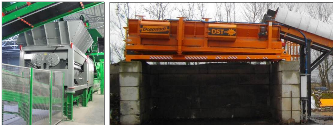
Rysunek 3.3. Rozdrabniacz wolnoobrotowy (z lewej), sito gwiaździste – wolnostojące (z prawej) fot. proGEO
