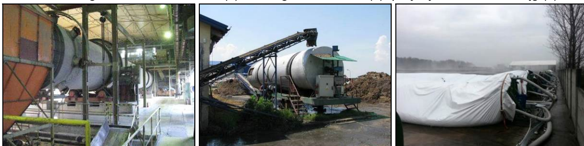
Biostabilizator M-U-T Dano, Radiowo (8), komposter M16, Paszczyna (9), rękawy foliowe, Lubin (10)
